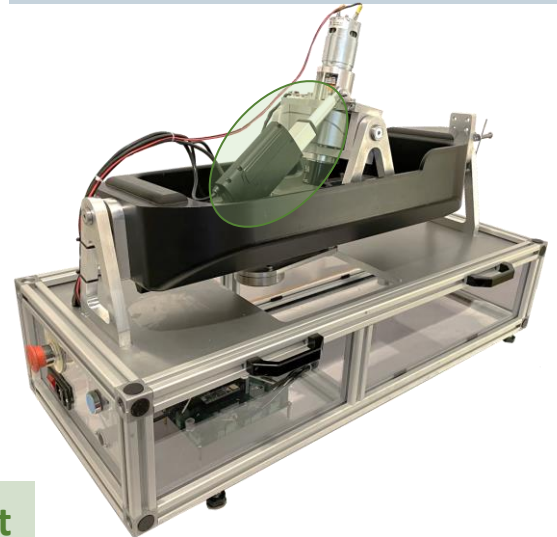
Stabilisateur gyroscopique de bateau
