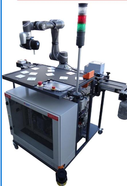
ON10: « Robot collaboratif de Dévissage 2D & Assemblage-Vissage » en configuration ErmaSmart Assemblage
