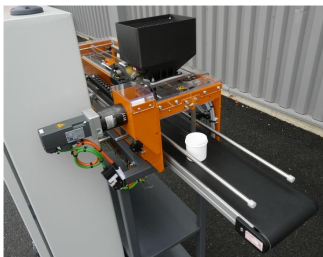
Partie opérative Dosaxe avec Module de dosage de granulés dans des pots/flacons
