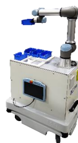
AGV Mir100 avec bras collaboratif UR eSeries
