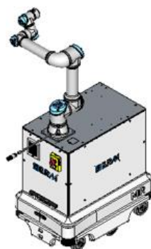
AGV MiR100 avec bras collaboratif UR eSeries
