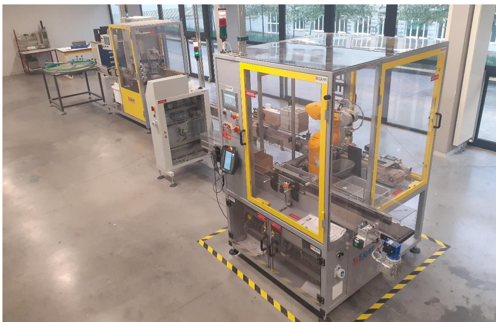
Cellule robotisée intégrée à la ligne Ermaflex
