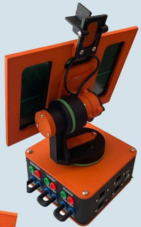
Points de mesures, tension et intensité de la puissance produite et stockée (panneau, charge, batterie).
