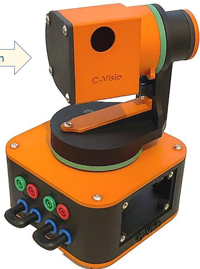
Caméra de visioconférence avec 2 axes motorisés, instrumentés et pilotés par IA
