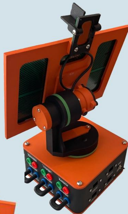
Points de mesures, tension et intensité de la puissance produite et stockée (panneau, charge, batterie).
