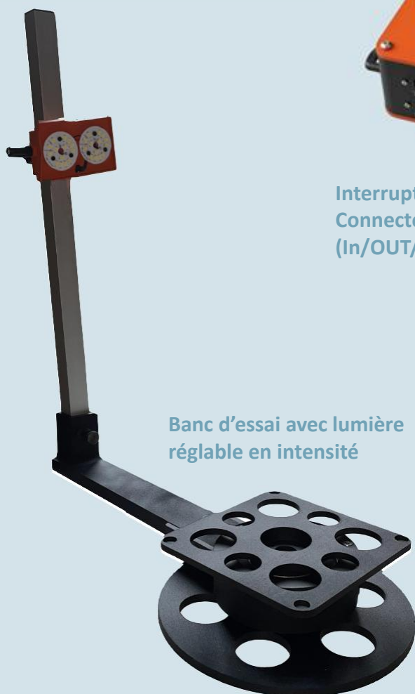
Points de mesures (tension et intensité) de la puissance consommée par les 2 motoréducteurs
