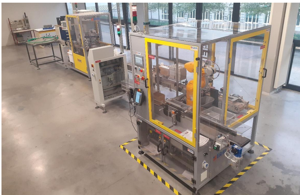
Cellule robotisée intégrée à la ligne Ermaflex
