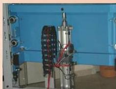
2 cilindros hidráulicos doble efecto (utilizados en simple) montados en tándem
