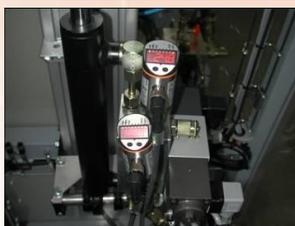
Cilindro hidráulico instrumentado
