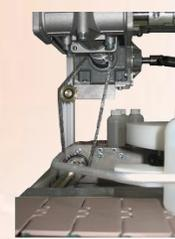
Alineación de los piñones accionando el eje motor de los transportadores
