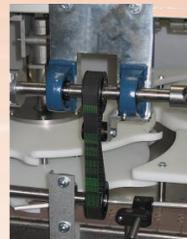
Alineación de las poleas asegurando la rotación del tornillo sin fin desde el motor
